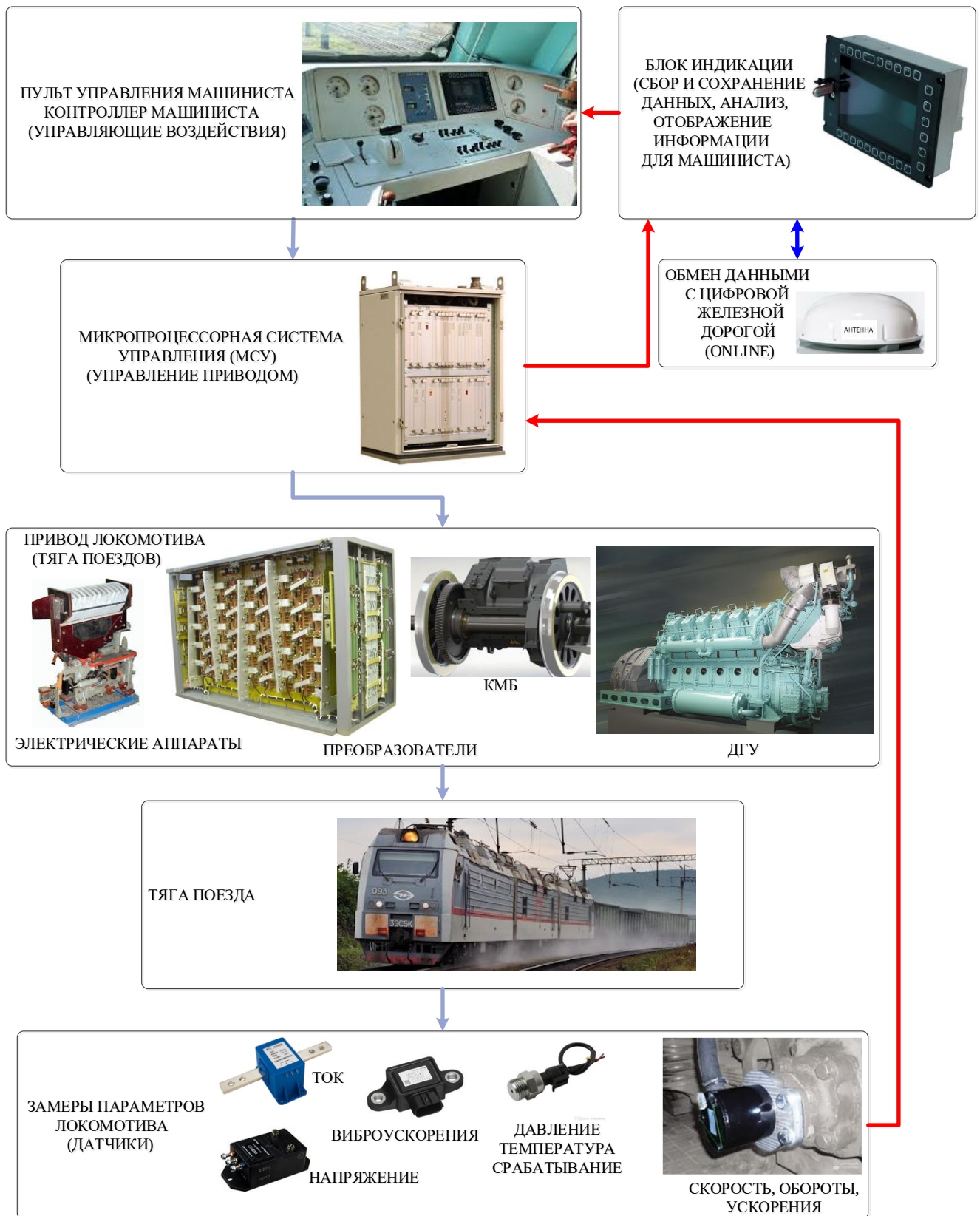
Рисунок 3.9 – Типовая структура управления локомотивом на базе МСУ
