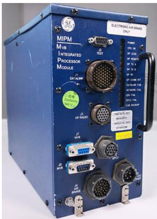
Рисунок 1.3 – Бортовая система мониторинга состояния локомотивов General Electric
