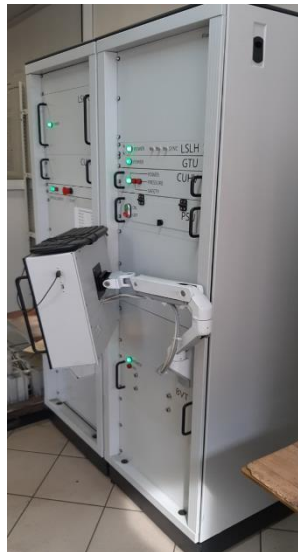
в - Комплектация тиристорных блоков
