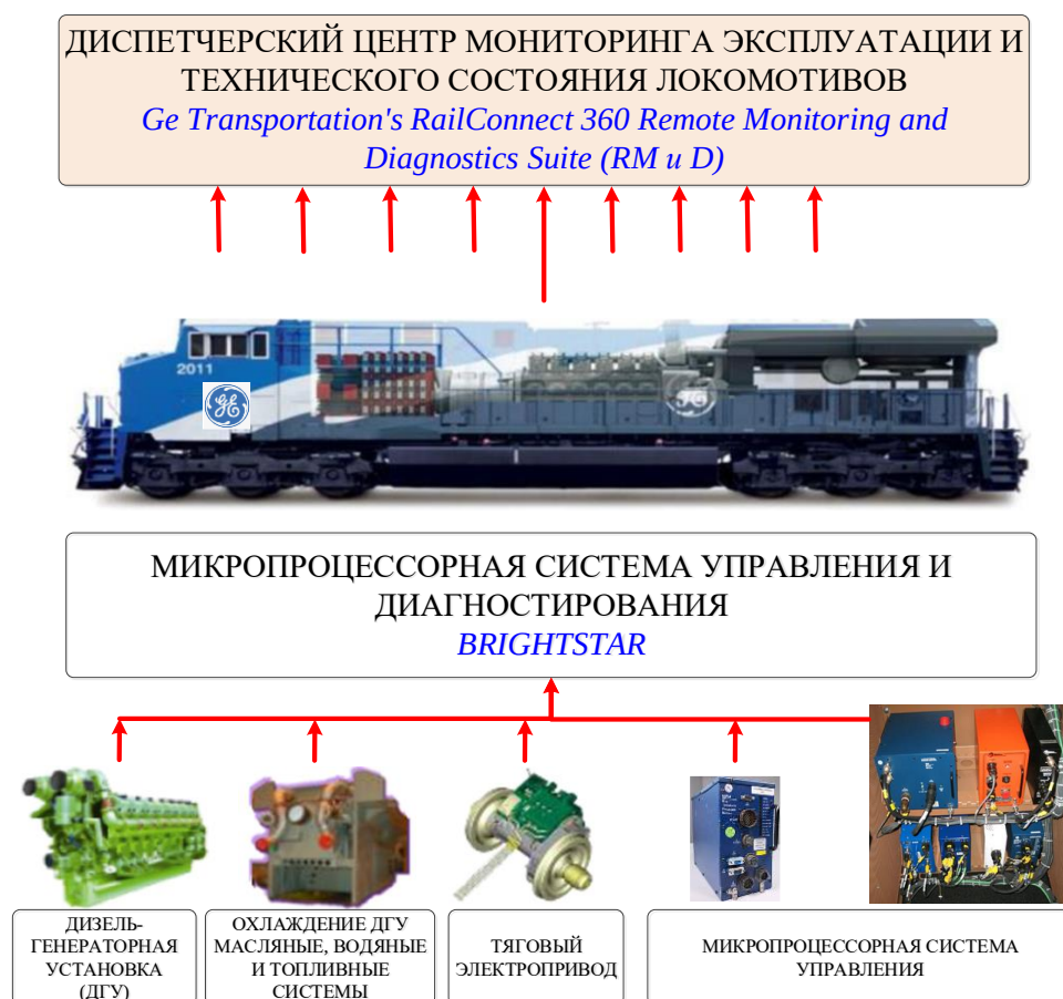
Рисунок 1.4 – Схема сбора информации с тепловозов компании General Electric
