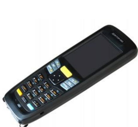
а – прибор для диагностики электрических машин и аппаратов «Доктор-60»
