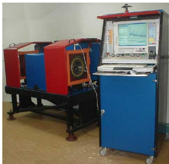
Рисунок 3.26 – Стенд входного контроля подшипников ТЭД
