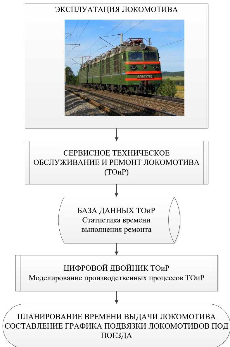
Рисунок 5.2 – Место Цифрового двойника в системе оперативного управления ТОиР локомотивов [271, 278]
