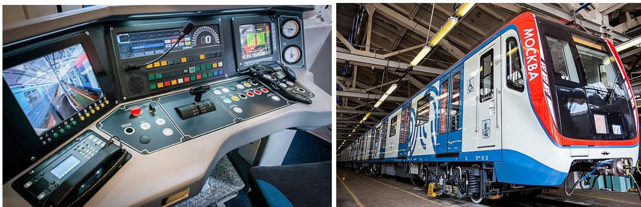
Рисунок 1.13 – Пульт машиниста электропоезда «Москва»
