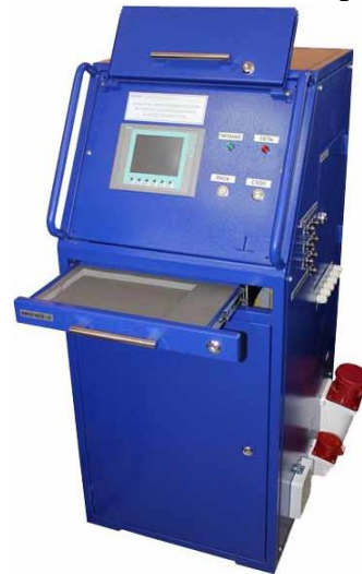
г – источник собственных нужд для прокрутки ТЭД
