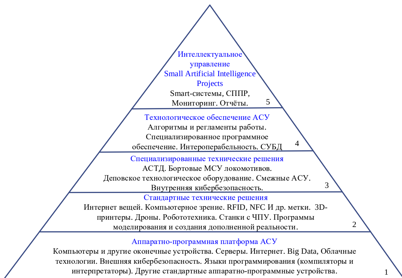
Рисунок 6.3 – Технологическая структура АСУ жизненного цикла локомотивов и её аппаратно-программные средства
