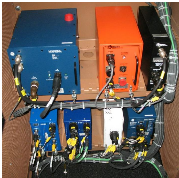
Рисунок 1.3 – Бортовая система мониторинга состояния локомотивов General Electric
