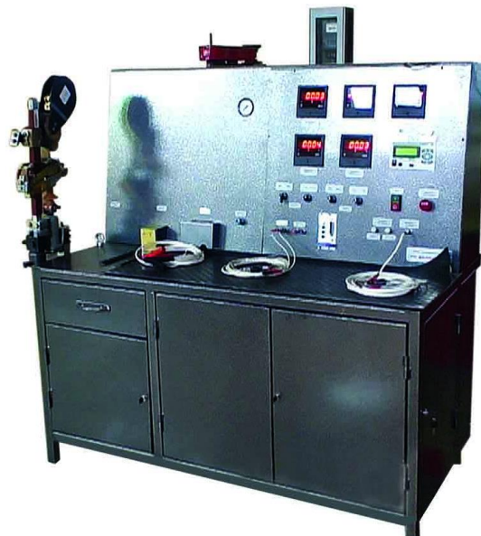
б – стенд испытания и наладки электрических аппаратов
